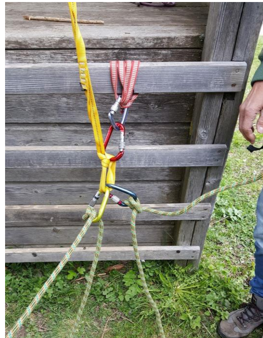
Reihenverankerung mit Bandschlinge „Weiches Auge“
